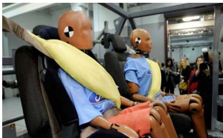
Рис. 3.7. Ремни безопасности со встроенными надувными элементами в момент срабатывания пиропатронов при испытании системы
