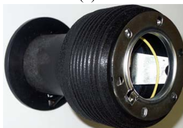
Рис. 3.20. Травмобезопасная проставка под рулевое колесо (сильфон)
