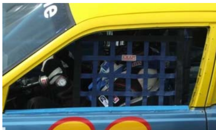
Рис. 3.17. Страховочная сетка на окне спортивного автомобиля
